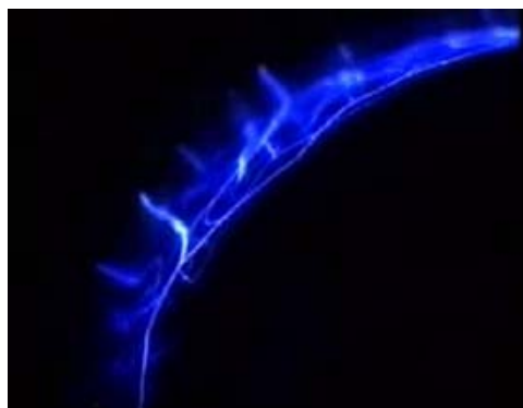
Imágenes 1 y 2: Descarga eléctrica alrededor de los tubos de vidrio, donde se genera el ozono, en el interior del generador y detalle de la corona.
